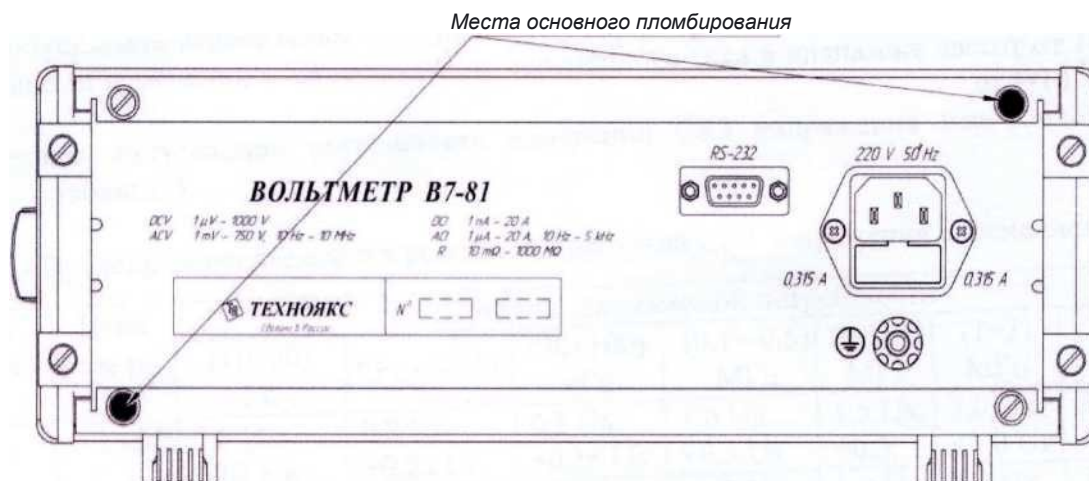
Рисунок 2 - Схема пломбировки от несанкционированного доступа
